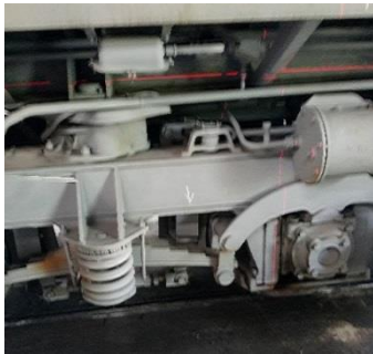
Рисунок 2. Організація процесу вимірювання геометрії рами кузова: а) встановлений рівень горизонту для проведення замірів; б) схема розташування нівелірів.
